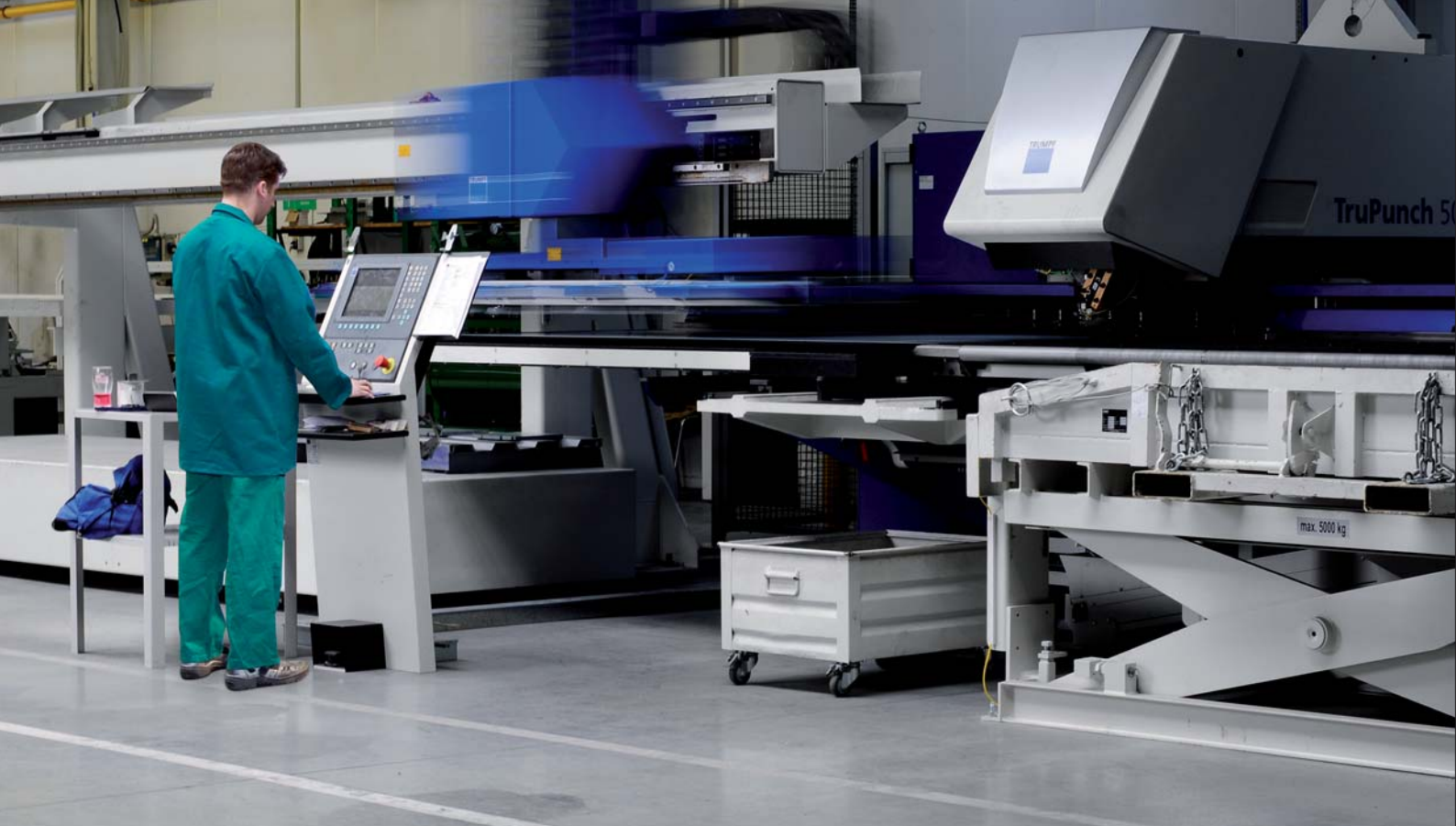
▲ Operátor pri obsluhu vysekávacieho stroja, ktorý slúži na strihanie tenkých plechov na báze CNC (computer numerical control) zariadení.
