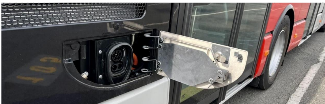
Obrázok 1 Zásuvka CCS-2 na autobuse DPP Iveco Urbanway Hybrid 18M vďaka ktorej spĺňa smernicu 2009/33/ES (Foto: DPP Dominika Brabcová)
